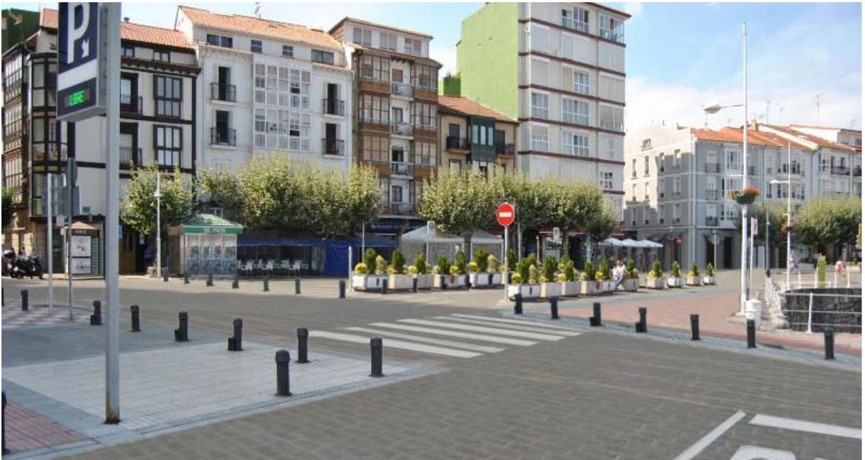
*Imagen 38. Infografía de ordenación del tráfico y aparcamiento en la Plazuela, eliminando el estacionamiento y delimitando físicamente la calzada de circulación vehicular.*
